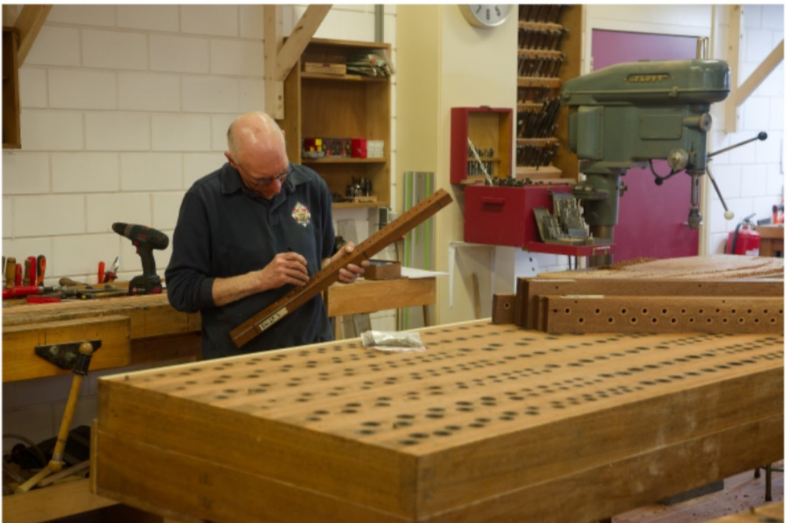
Bert van den Heuvel, orgelbouwer, is aan het werk aan de windlade, waar normaal gesproken de pijpen op staan.
