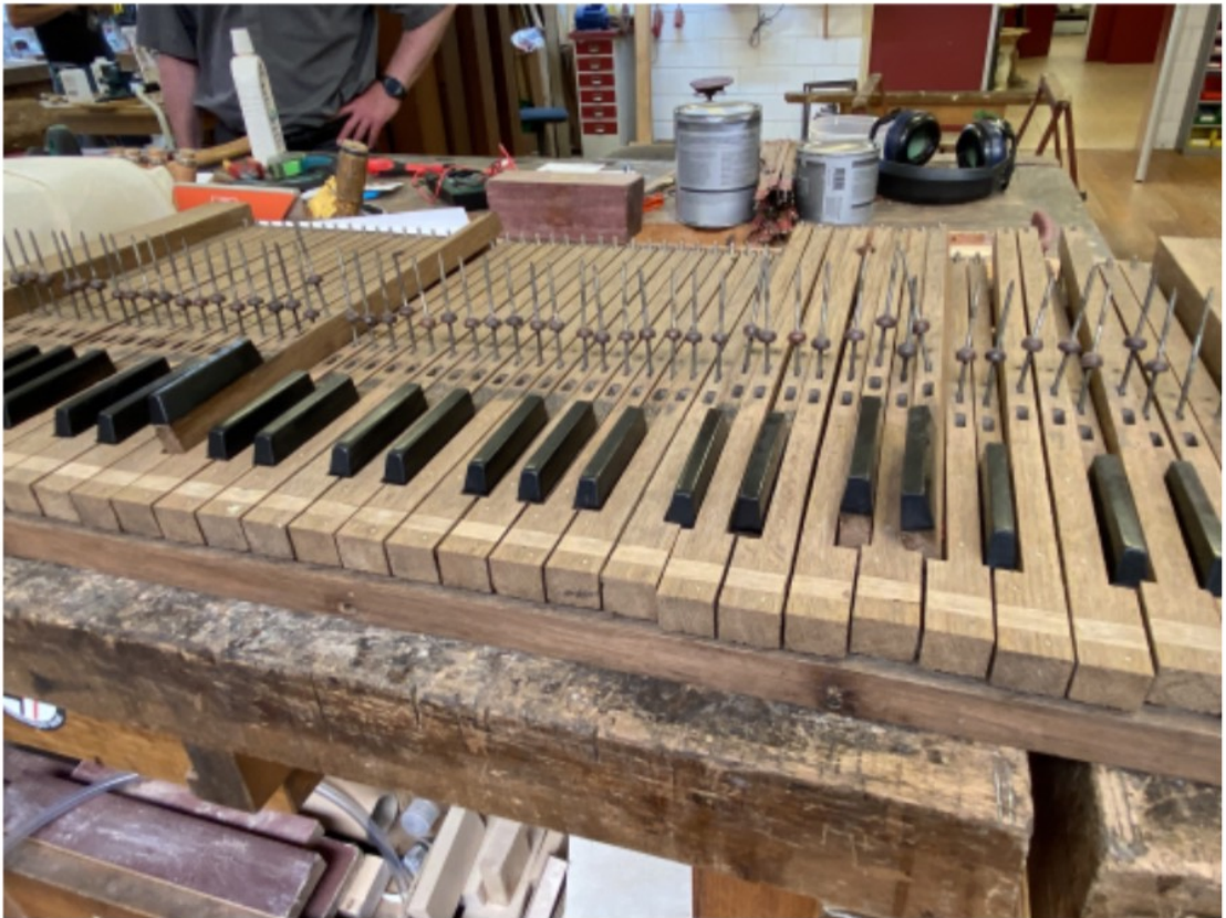
Een van de klavieren tijdens de restauratie in de werkplaats voordat ze opnieuw werden belegd met been.
